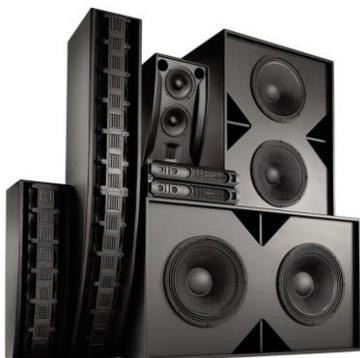
繊細な高音域の再現性でプロフェッショナルに圧倒的な支持を得てきたリボンドライバー方式をシネマ用スピーカーに採用。また複数のスピーカーを直線状に並べたラインレイ方式により、音の指向性が高まり、音が上下に拡散しないため、客席の前方から後方まで均一に音を届けることを可能にし、劇場内の「音のスイートスポット」を拡大します。
